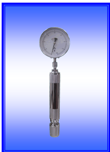
蒸気圧ポンベおよび圧力計
